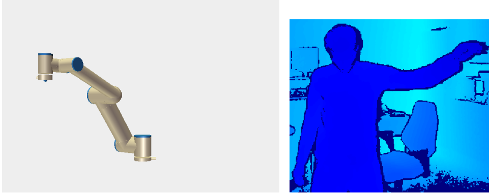
Kuva 4.8 Vaihto vasempaan käteen. Vasemmalla kuva URsim-robottisimulaattorista, oikealla iai_kinect2:n tuottama väritetty syvyyskuva.
